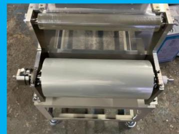
加熱プレート：アルミ製下部にヒーター シリコンラバーヒーター200V
